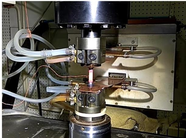
Figura 5.1 – Equipamento usado para os ensaios de tração.
