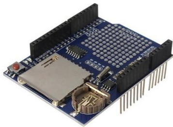
Figura A.7 – Especificações técnicas do shield RTC DS1307 para Arduino.
