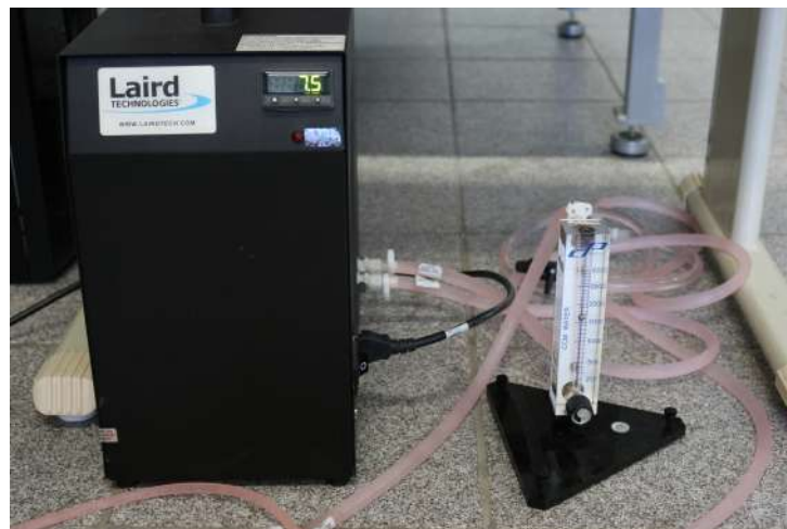
Figura A.12 – Chiller e medidor de fluxo
