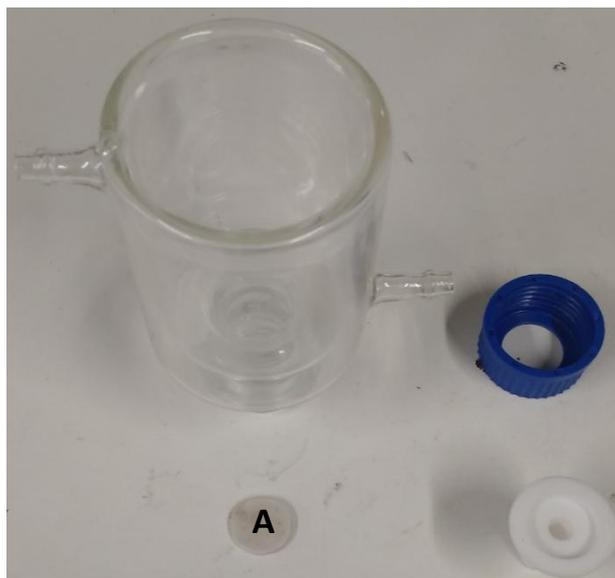
Figura 15 - Módulo de pervaporação construído. A: suporte poroso para membrana.
