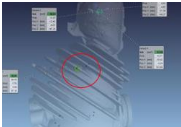
Figura 4. 14 Imagem de scanner de amostra vazada. Na região circulado em vermelho está indicado o defeito detectado pelo scanner.
