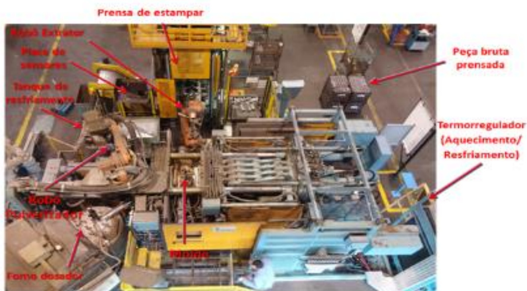
Figura 3.5 Célula de injeção sob pressão
