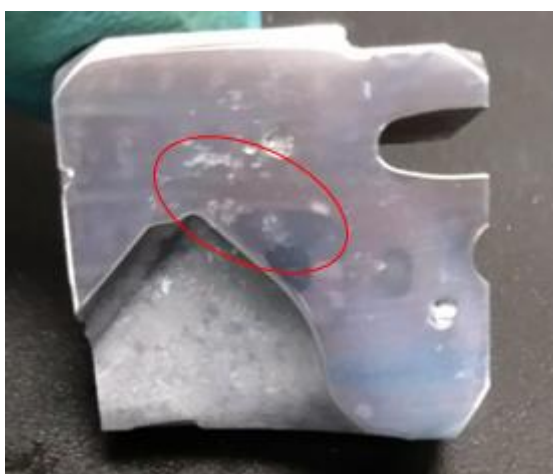
Figura 4. 24 Defeito de fundição (rechupe) identificado em amostra injetada no ponto 7A
