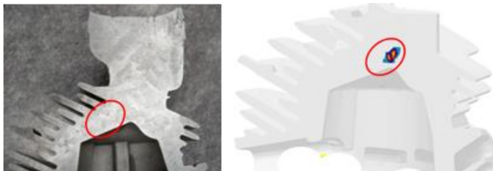
Figura 4. 12 Comparação entre SDAS e o software de simulação. As regiões circuladas indicam o defeito previsto pelo SDAS (à esquerda) e o defeito previsto pelo software de simulação (à direita).
