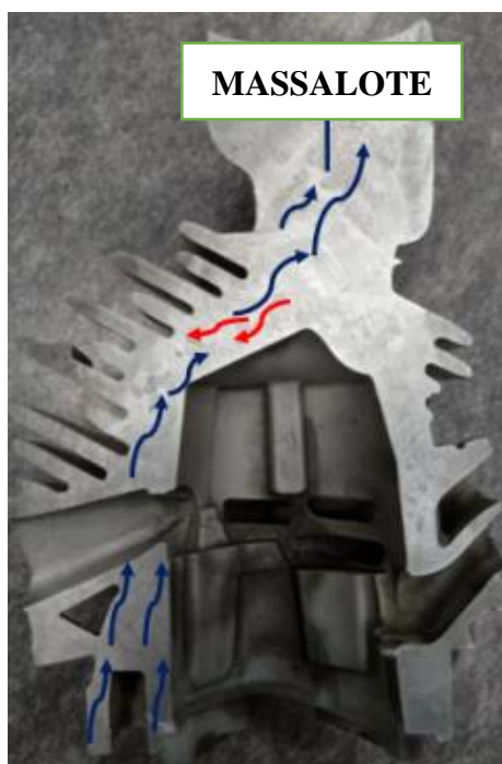
Figura 4. 11 Flechas indicando o sentido de solidificação do Lado B em direção ao massalote, apresentando região com sentido de solidificação incorreto (flechas em vermelho), conforme os valores encontrados SDAS.
