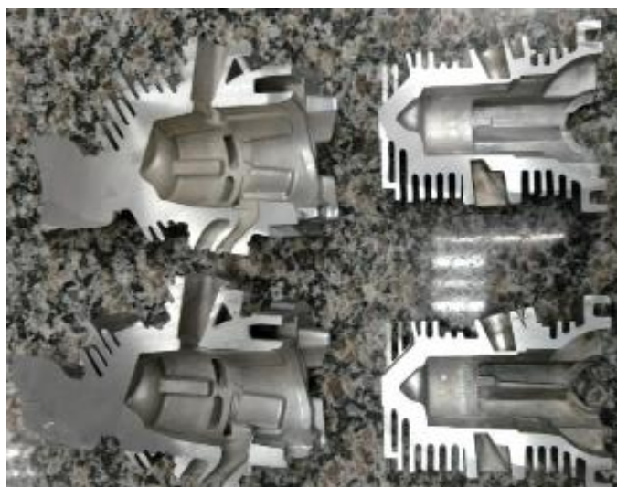
Figura 3. 7 Amostras vazadas (esquerda) e amostras injetadas (direita) prontas para realização do ensaio de dureza
