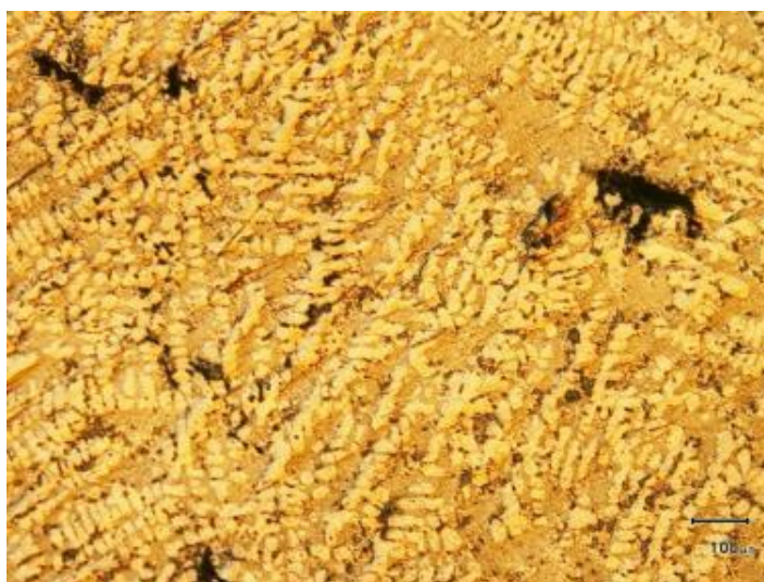
Figura 4. 29 Ponto 3A-SDAS=22,7 \mu\text{m} , com potencial de pite de -303 mV. Regiões de dissolução de dendritas e fases em contornos das dendritas.
