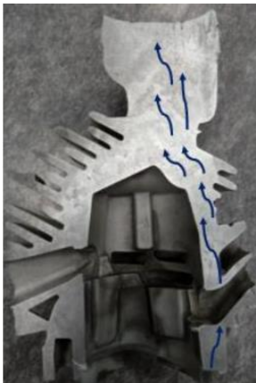
Figura 4.9 Flechas indicando o sentido de solidificação do Lado A em direção ao massalote, conforme os valores encontrados SDAS.
