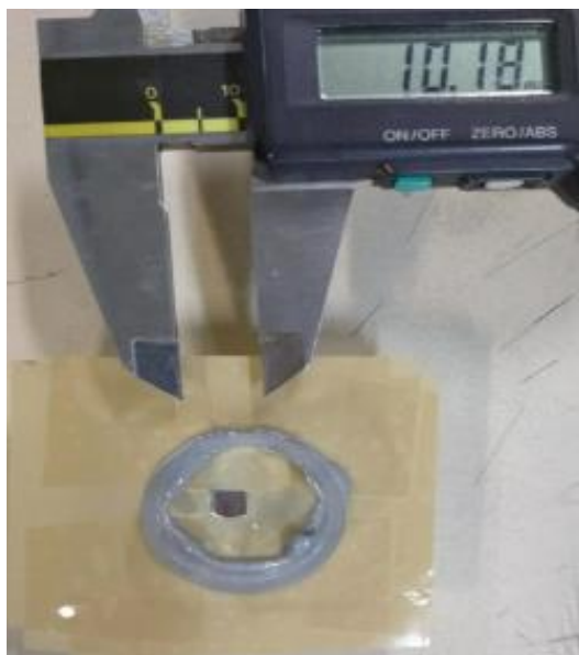
Figura 3. 14 Medição da área isolado com paquímetro para obter escala de referência em mm
