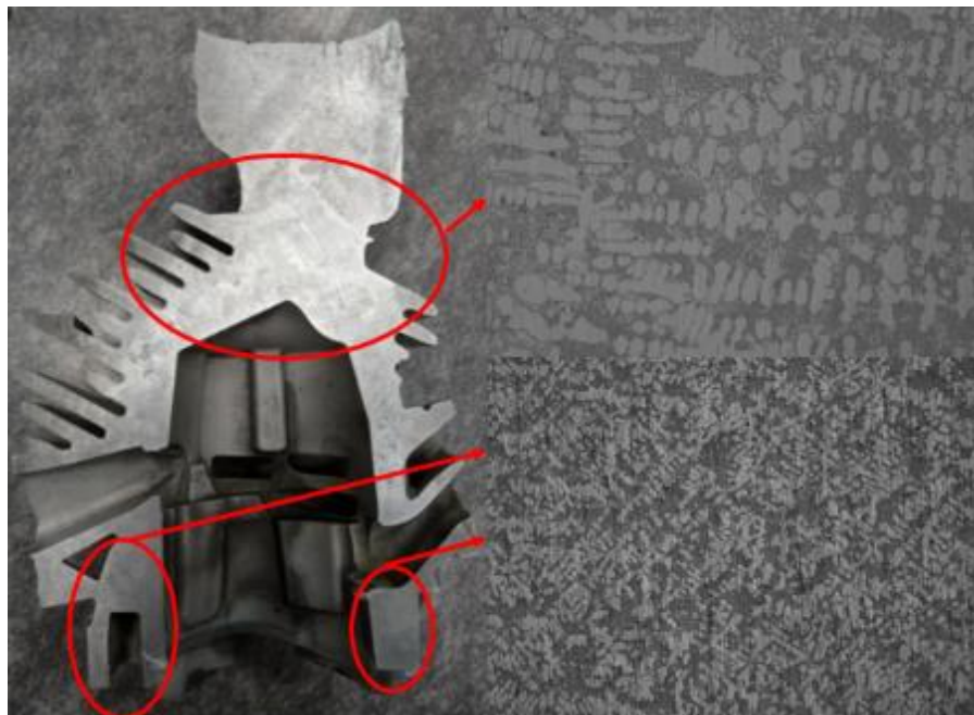
Figura 4. 6 Diferença de microestruturas em diferentes regiões da amostra vazada em Fundição por Gravidade. Na região acima circulada indica áreas com maiores tempos locais de solidificação, resultando em uma microestrutura grosseira. Nas regiões circuladas a baixo da amostra, indicam áreas com menores tempos locais de solidificação, resultando em microestruturas mais refinadas.
