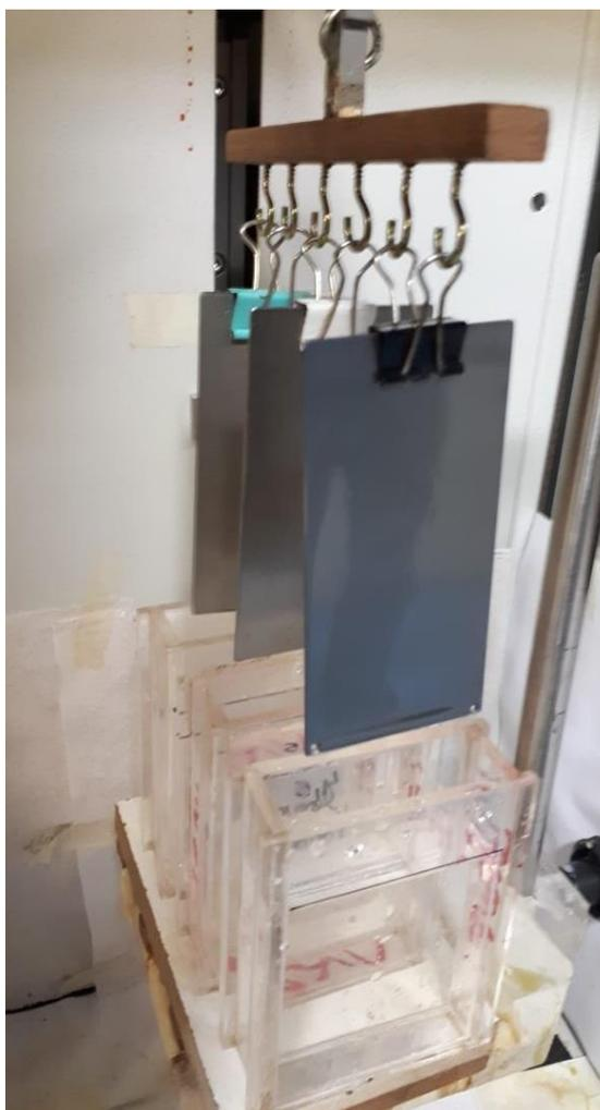
*Figura 15: Chapas de aço galvanizado momentos antes de serem imersas pelo método de dip coating.*
