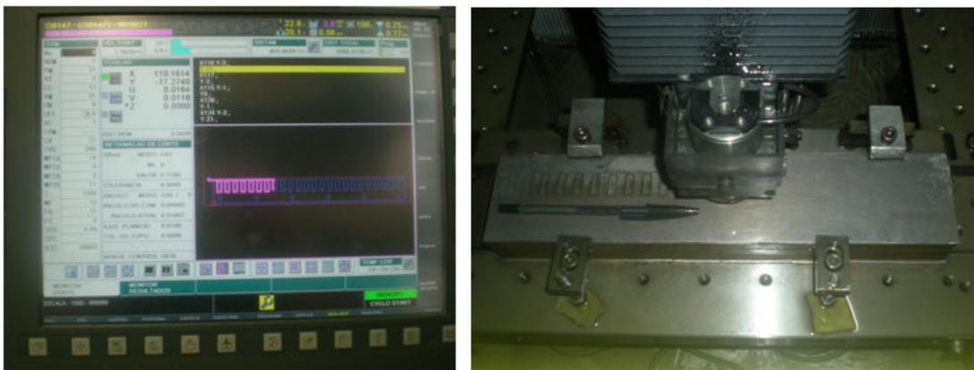
**Figura 43 Corte das chapas na máquina de eletroerosão a fio.**
