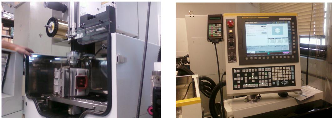
**Figura 19** Máquina de eletroerosão a fio.
