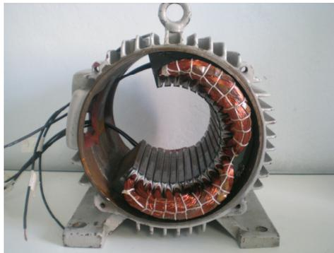
**Figura 21 Estator da máquina setorial com o novo enrolamento.**
