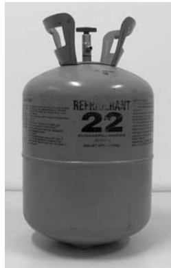
Figura 2 – Recipiente (botijão) que acondiciona gás para equipamentos de refrigeração
