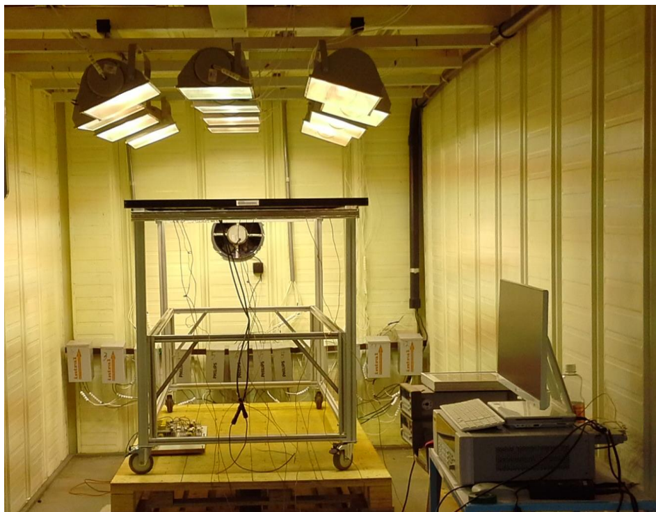
Figura 5.6 – Exposição a irradiação simulada de um módulo FV na câmara de exposição classe C, com nove sensores de temperatura fixados na face posterior do módulo, para verificação da uniformidade de temperatura.
