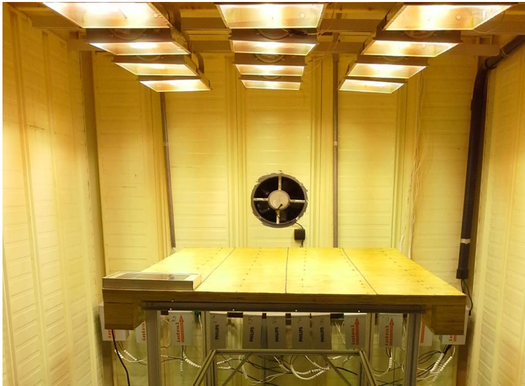
Figura 5.1 – Matriz do plano de ensaio do módulo FV com uma célula de referência em um ponto para medição da não uniformidade da irradiância da fonte de iluminação.
