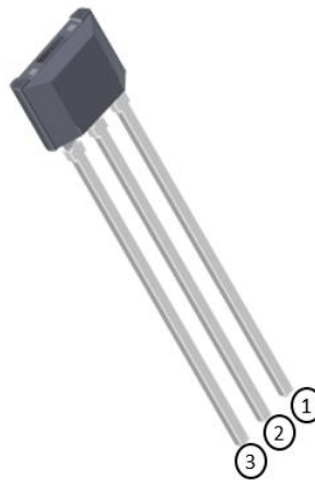
Figura 25 - Pinagem e foto do sensor A3213
