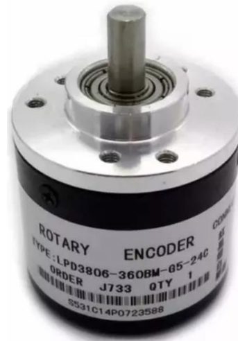
Figura 34 - Encoder incremental escolhido para projeto
