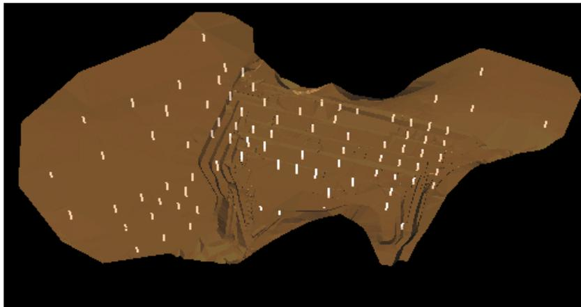
Figura 52 – Vista isométrica da topografia, bancadas de lavra e limite da área e furos de sondagem.
