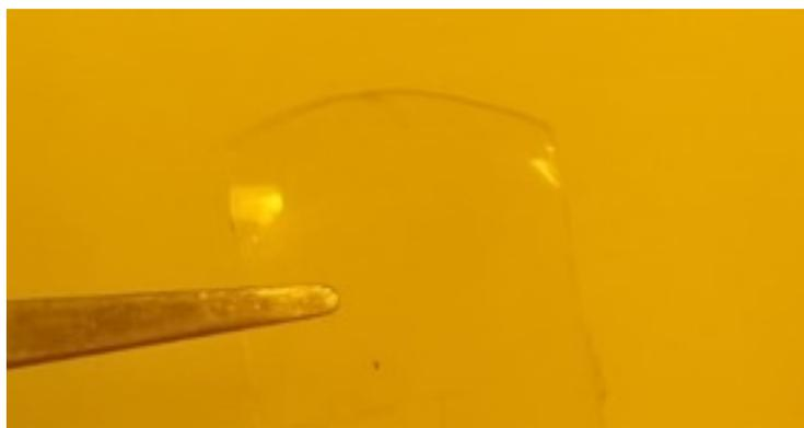
**Fig. 3.3:** Filme de  $\text{WO}_3 + \text{PVA}$  transparente e flexível obtido pelo método sol-gel, representação da amostra Sol70.
