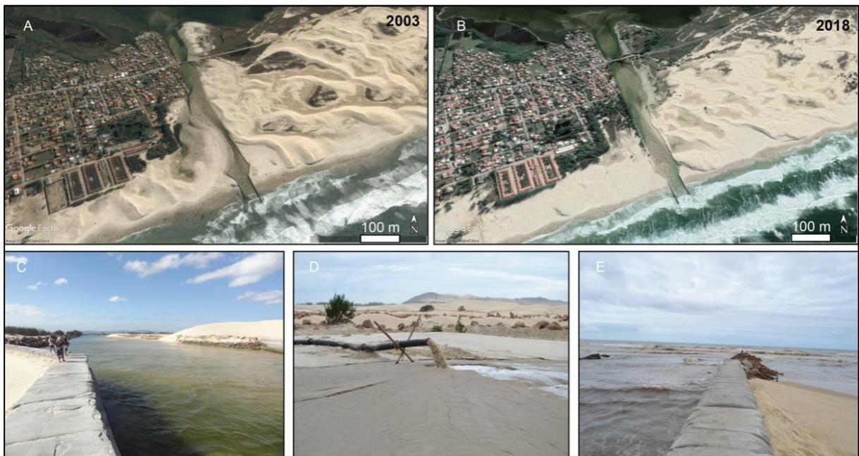
Figura 17: O Canal artificial do Camacho em 2003 (a) e em 2018 (b); Os sedimentos eólicos sendo depositados dentro do canal (c); a dragagem do canal (d); e a desembocadura do canal aberta (e). Fotos: Labgerco-UFRGS
