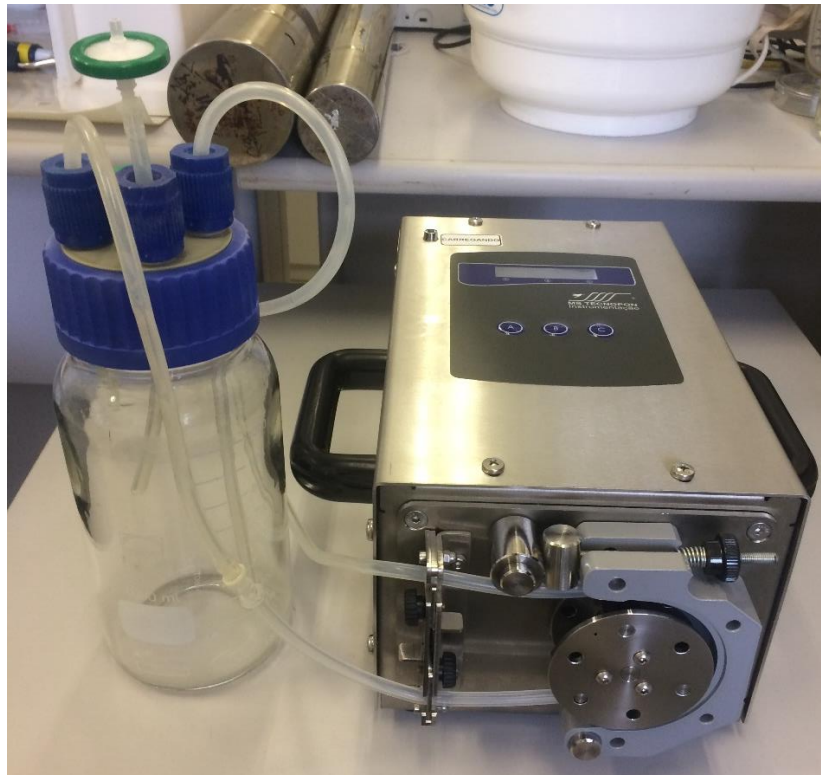
Figura 9: Biorreator de perfusão para descelularização e recelularização montado no Laboratório de Hematologia e Células-tronco, Faculdade de Farmácia, UFRGS.
