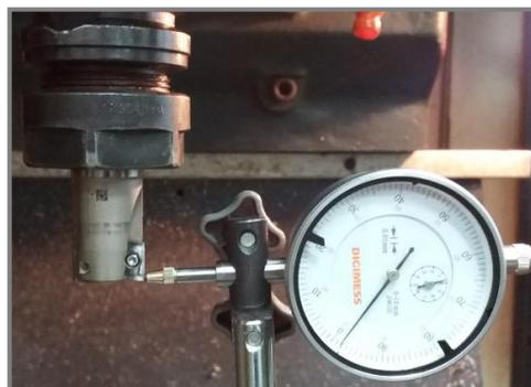
Figura 3.4 – Verificação do erro de batimento radial da fresa com relógio comparador.
