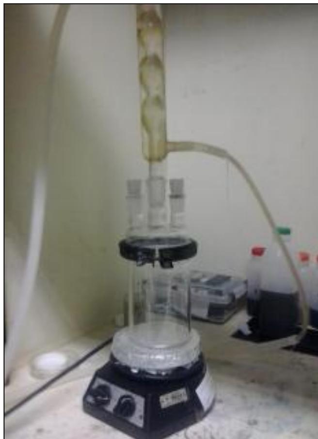
Figura 7: Reator para Digestão com Sistema de Refluxo
