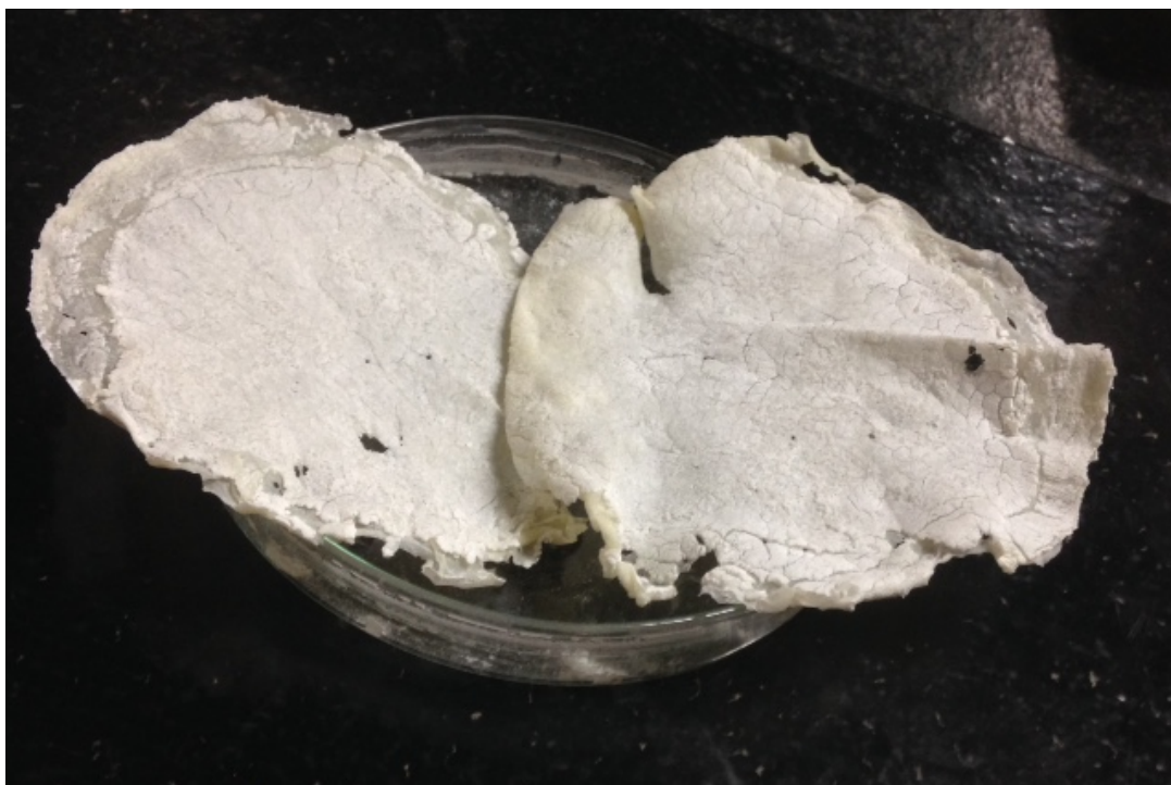
Fig. 27. Separação entre PLGA e NR no filme obtido por evaporação do THF durante a noite.
