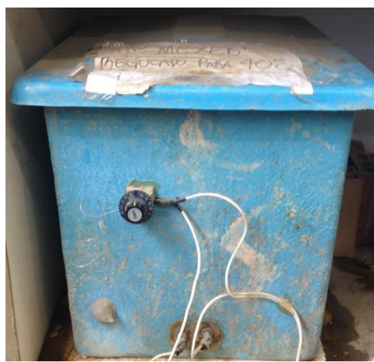
Figura 25: Tanque para cura a 40°C (foto do autor)
