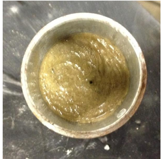
Figura 29: Amostra após conclusão do pinhole test (foto do autor)
