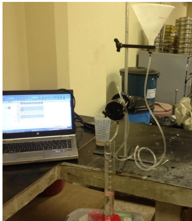
Figura 30: Pinhole test em andamento (foto do autor)
