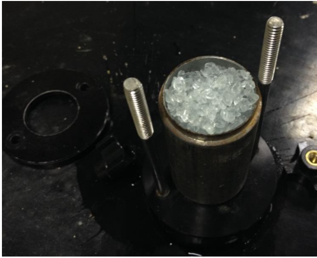
Figura 28: Molde preenchido e pronto para o pinhole test (foto do autor)
