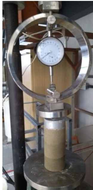
Figura 26: Ensaio de compressão simples (foto do autor)
