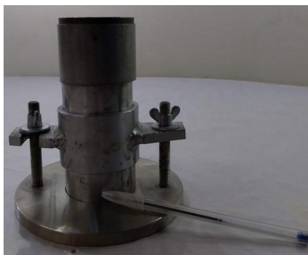
Figura 23: Moldes metálicos para moldagem (foto do autor)
