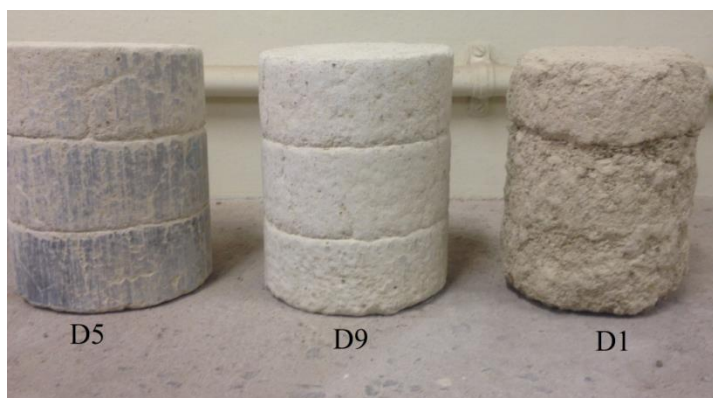
Figura 80: Algumas amostras após o fim do ensaio de durabilidade (foto do autor)
