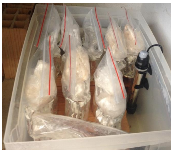
Figura 24: Tanque para cura a 23°C (foto do autor)
