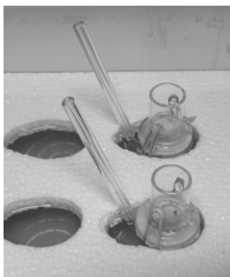
Figura 2 – Capítulo III. Célula de Franz manual utilizada para o estudo de permeação/penetração cutânea.
