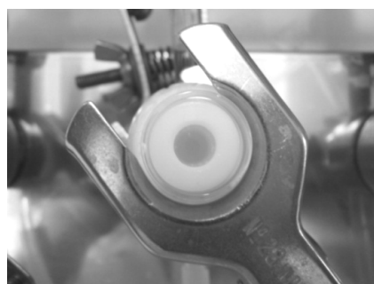
Figura 5 – Capítulo VI. Célula de Franz manual com aplicação de suspensão de nanocápsulas fluorescentes na superfície da pele
