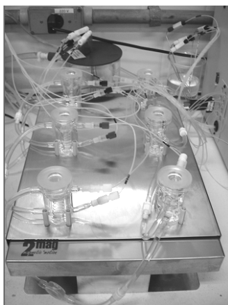
Figura 4 – Capítulo IV. Células automáticas de Franz (Microette Plus ® , Hanson Research)
