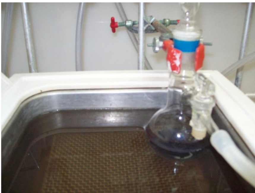
Figura 22. Ultrassonificação da suspensão de grafite expandido (GE) em hexano.
