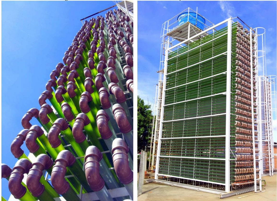
Figura 22. Fotobioreator tubular desenvolvido pelo NPDEAS.
