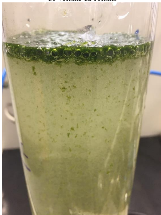
Figura 62. Concentração de biomassa de microalga via FAD. Condições: pH = 8,0; 150 mg/L \text{FeCl}_3 \cdot 6\text{H}_2\text{O} ; agitação rápida = 300 RPM; agitação lenta = 50 RPM; 2 mg/L de Floerger AN 956 SH; taxa de reciclo de 20% do volume da coluna.
