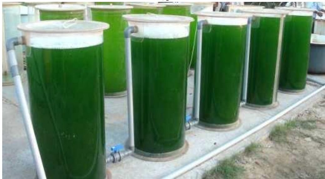
Figura 24. Fotobioreatores tubulares com uso de bolhas para revolvimento das algas e fornecimento de CO 2 e O 2 .
