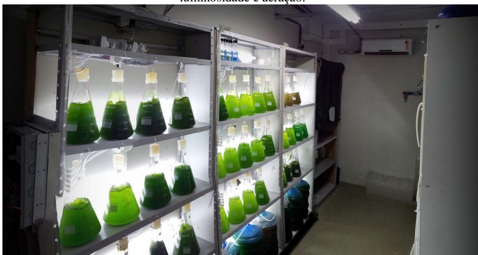
Figura 21. Sala de cultivo de microalgas, montada de forma independente, com controle de temperatura, luminosidade e aeração.
