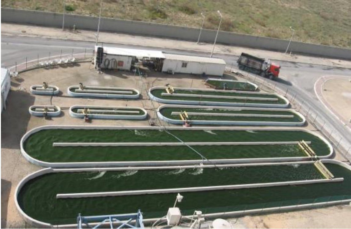
Figura 23. Raceway clássico, implantado pelo Massachusetts Institute of Technology (MIT) durante a missão Terrascope 2014.
