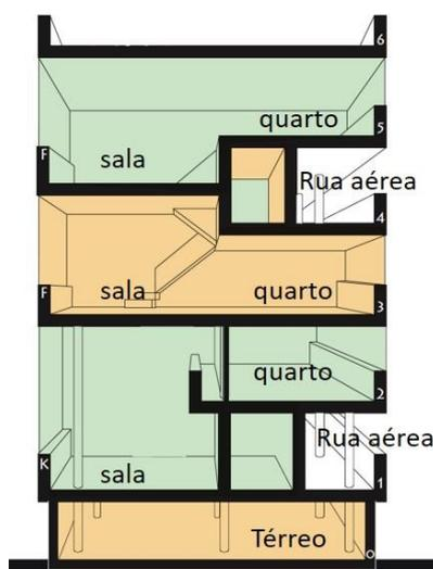
**Figura 13:** Seção do edifício que mostra apartamentos do tipo K e F.
