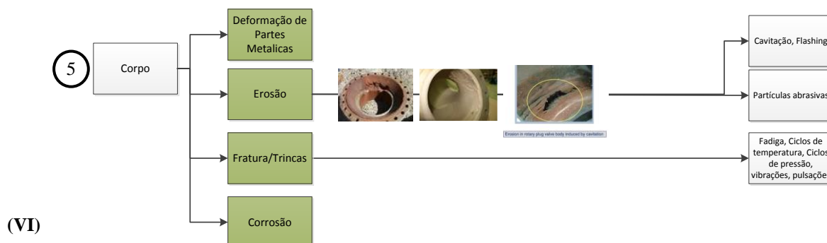
Figura 53 - Falhas e defeitos característicos em válvulas do tipo esfera flutuante. I) Resumo do diagrama de falhas e defeitos característicos; II) III) IV) V) VI) Subseções do diagrama (1,2,3,4,5) – (Continuação)
