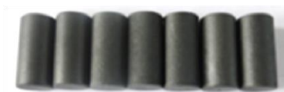
Figura 34 - Corpos de prova padronizados; Material: PTFE CompL .
