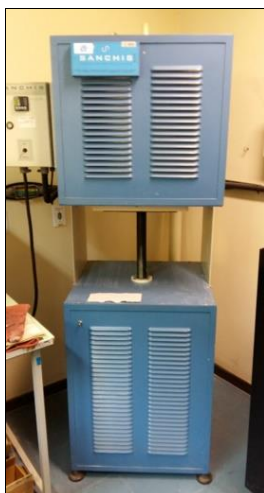
Figura 26: Estufa usada nos ensaios termogravimétricos (LACER – UFRGS).
