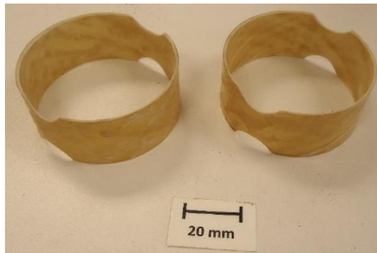
Figura 28: Corpos-de-prova baseados na ASTM D2290.
