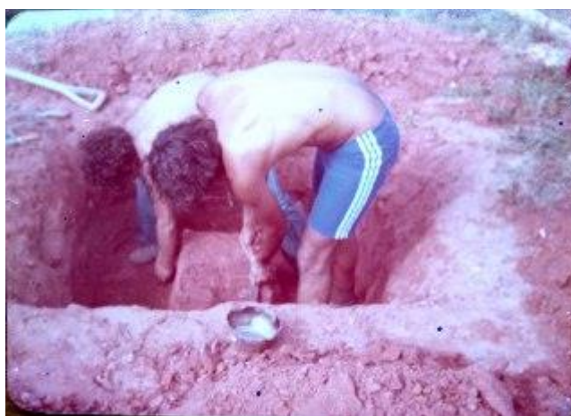
Figura 2: Extração de amostra “indeformável” de solo.
