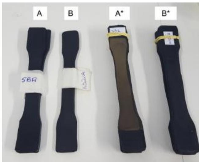
Figura 44 - Amostras comerciais de SBR (A) e Nitrílica (B) antes e após envelhecimento (\*)
