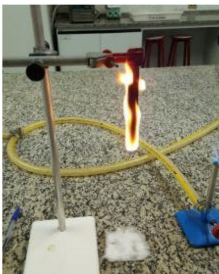
Figura 42 - Imagem da amostra com 2,5% de alumina no teste de flamabilidade pela norma UL94, método vertical
