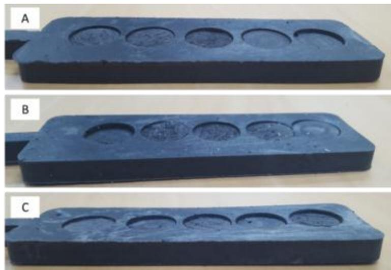
Figura 39- Comparação da perda de volume após ensaio de abrasão das amostras com: (A) 2,5% de ATH (B) 5,0% de ATH (C) 7,5% de ATH.
