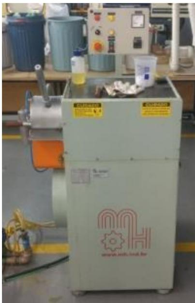
Figura 14– Máquina homogeneizadora de materiais para uso em laboratório.
