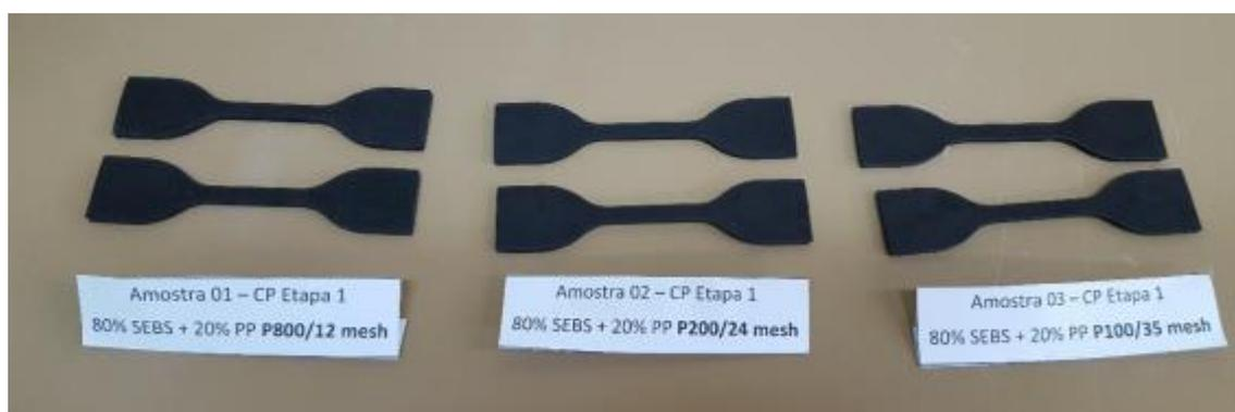
Figura 17– Corpos de prova produzidos com o uso da faca de corte.
