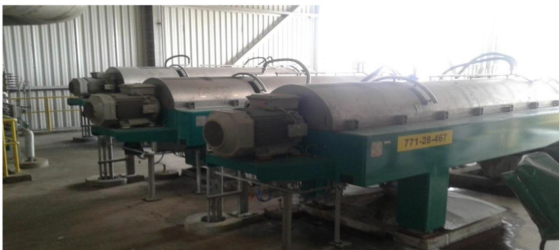
**Figura 5-Centrífugas do sistema de *ash leaching*. Fonte: Autor.**
