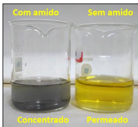
Figura 26. Teste de iodo (2 %) no concentrado e no permeado.
