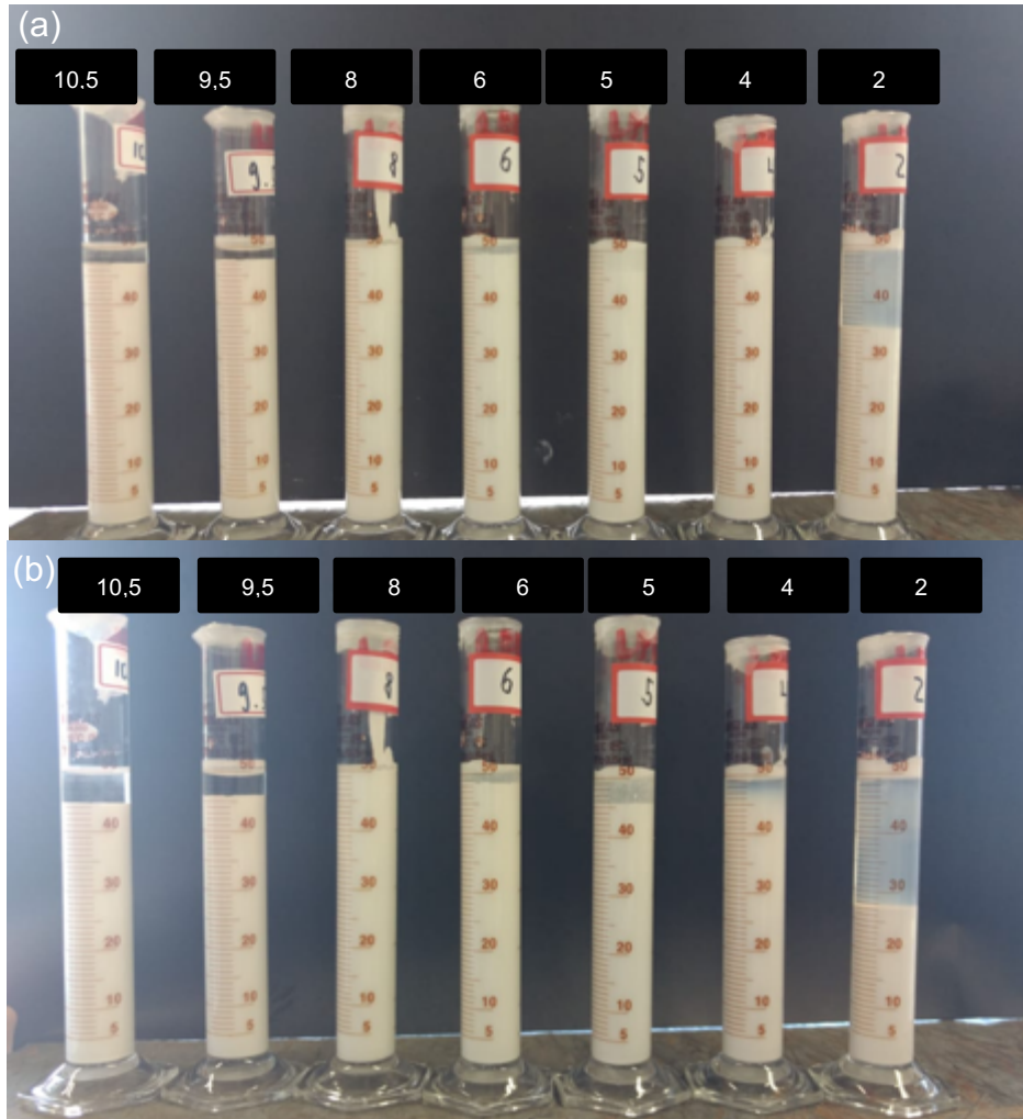
Figura 4-7: Fotografia do experimento de sedimentação das dispersões de alumina em diferentes pHs em função do tempo para (a) 1 dia e (b) 7 dias
