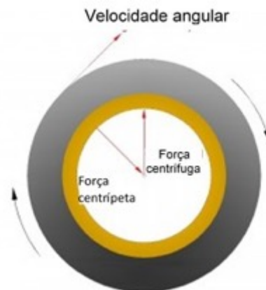
Figura 2-3. Representação esquemática das forças envolvidas no processo de centrifugal casting .
