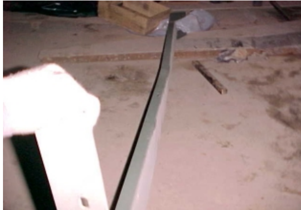
Figura 4.9 - Empenamento de longarina (estrutura da cabina)
