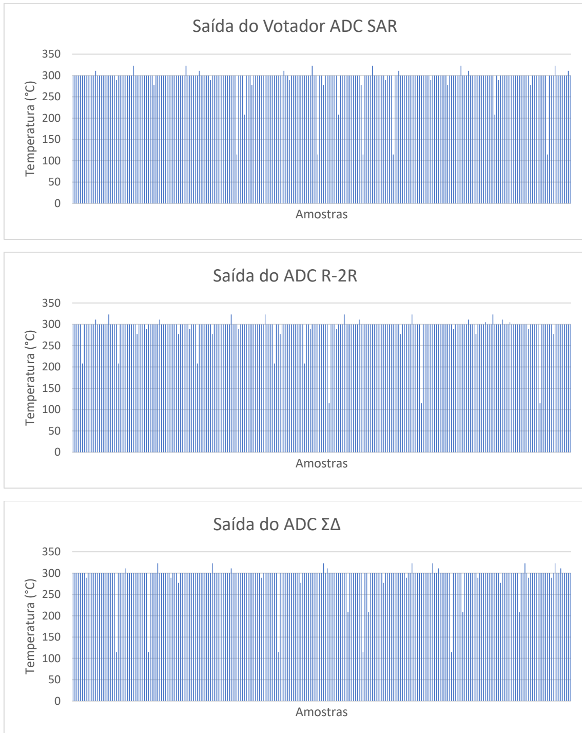
Figura 55 – Saída do SAD com temperatura de medição a 300°C.
