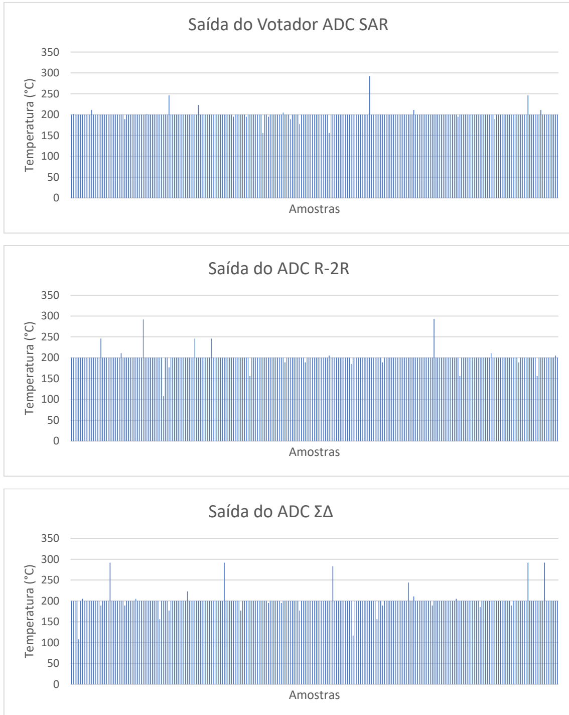
Figura 53 – Saída do SAD com temperatura de medição a 150°C.
