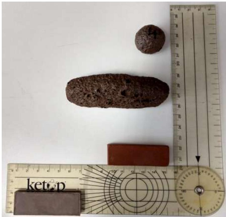
Figura 22 - Corpos de Prova antes e depois da queima a 1300°C.
