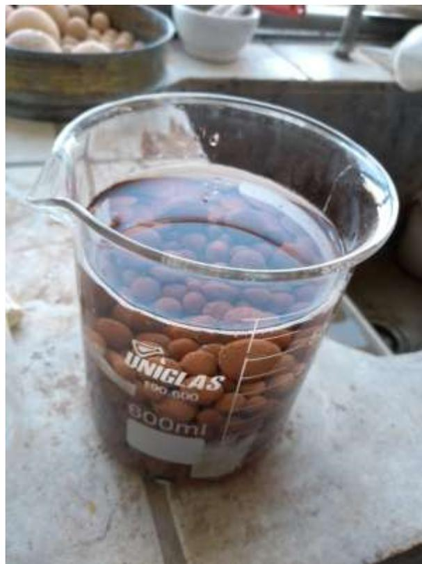
Figura 23 - Ensaio de Absorção do AAE-RS
