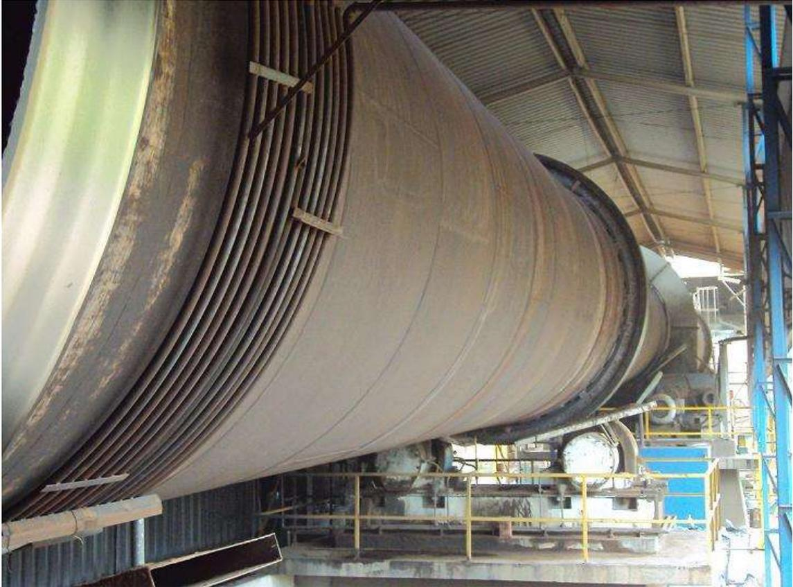
Figura 08- Forno Rotativo. Fonte: Cinexpan, (2018).
