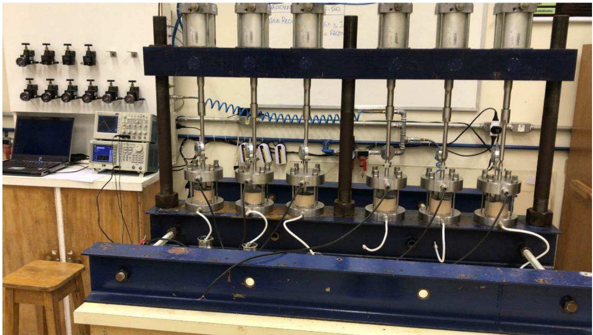
Figura 3.19 Equipamento de coluna modificado para ensaios adensamento unidimensional.
