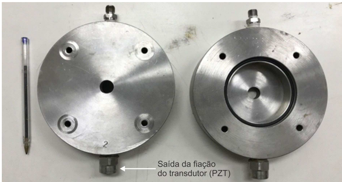
Figura 3.16 Tampa da câmara oedométrica com saída do cabo.
