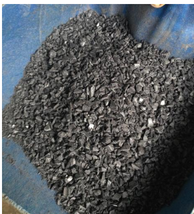
Figura 12 – Imagem do material após a 2ª etapa de moagem
