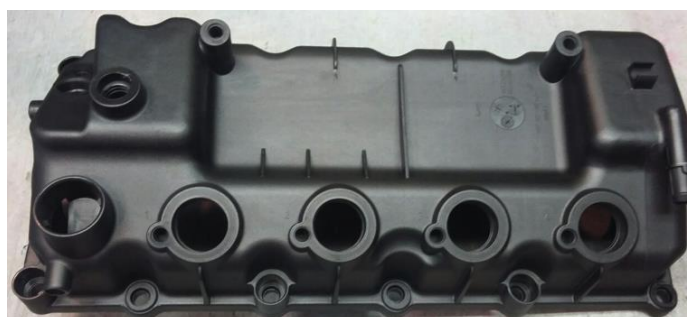
Figura 8 – Imagem da tampa de válvulas
