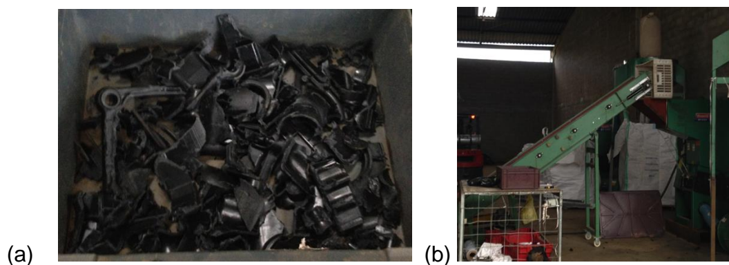
Figura 12 – Imagem do material após a 2ª etapa de moagem
