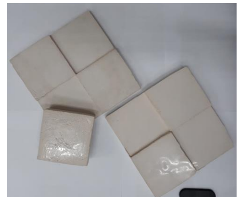
Figura 2 – Resultado obtido das placas desmoldadas, após cura.
