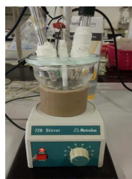
Figura 3: Célula voltamétrica com arranjo de três eletrodos usada nas determinações.
