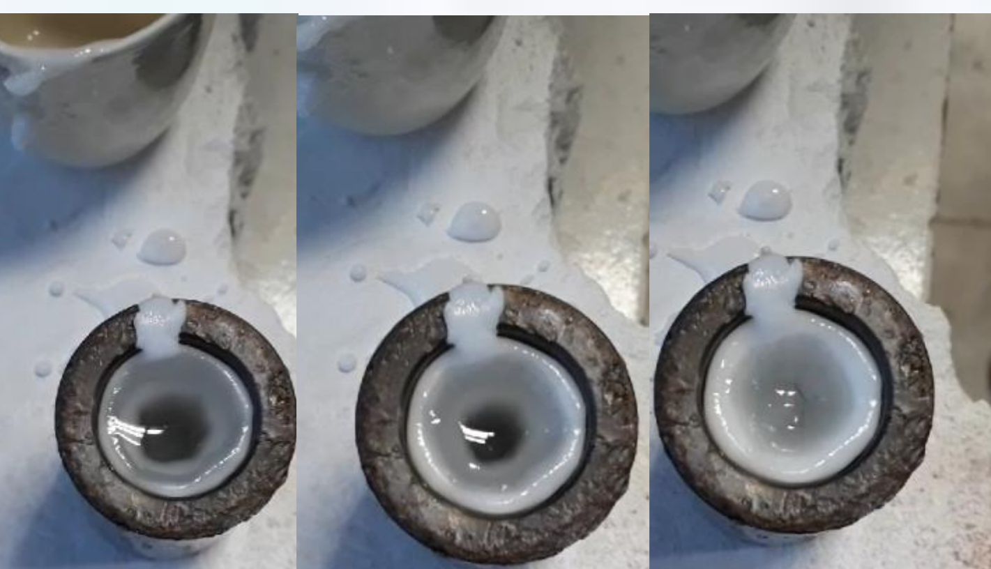
Figura 5: Sequência da solidificação do sal fundido, observando-se as contrações nos estados líquido e sólido.
