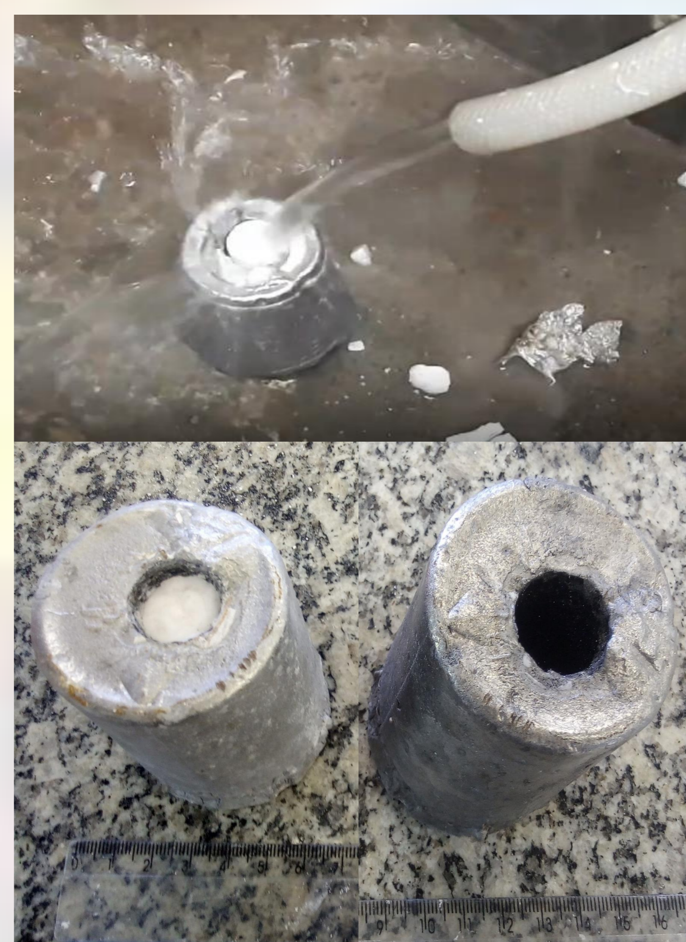
Figura 11: O ensaio da colapsibilidade, após a fundição de alumínio, demonstrou que a desmoldagem do sal fundido é satisfatória após poucos segundos sobre água corrente, para as três formulações estudadas. A hidratação e dissolução do sal fundido em água leva ao colapso instantâneo da peça, garantindo a formação da cavidade de acordo com a sua geometria.
