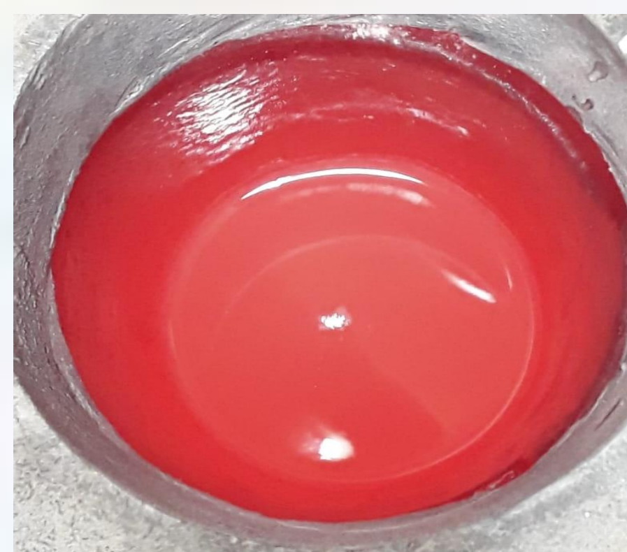
Figura 3: As amostras foram levadas à fusão em um forno mufla a 700°C.
