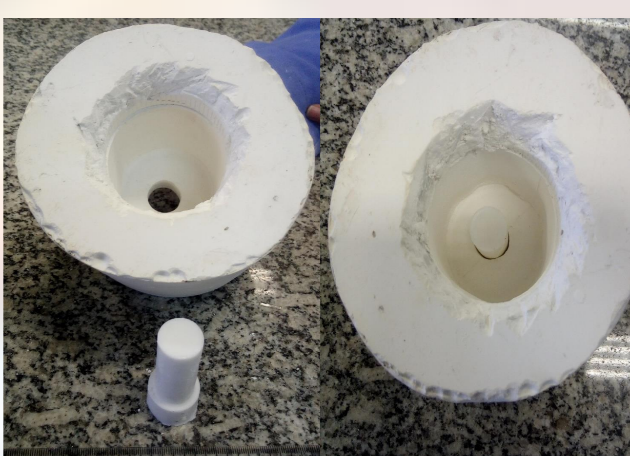
Figura 7: Sequência da montagem de um corpo-de-prova simulando um macho cerâmico, em um molde de gesso.
