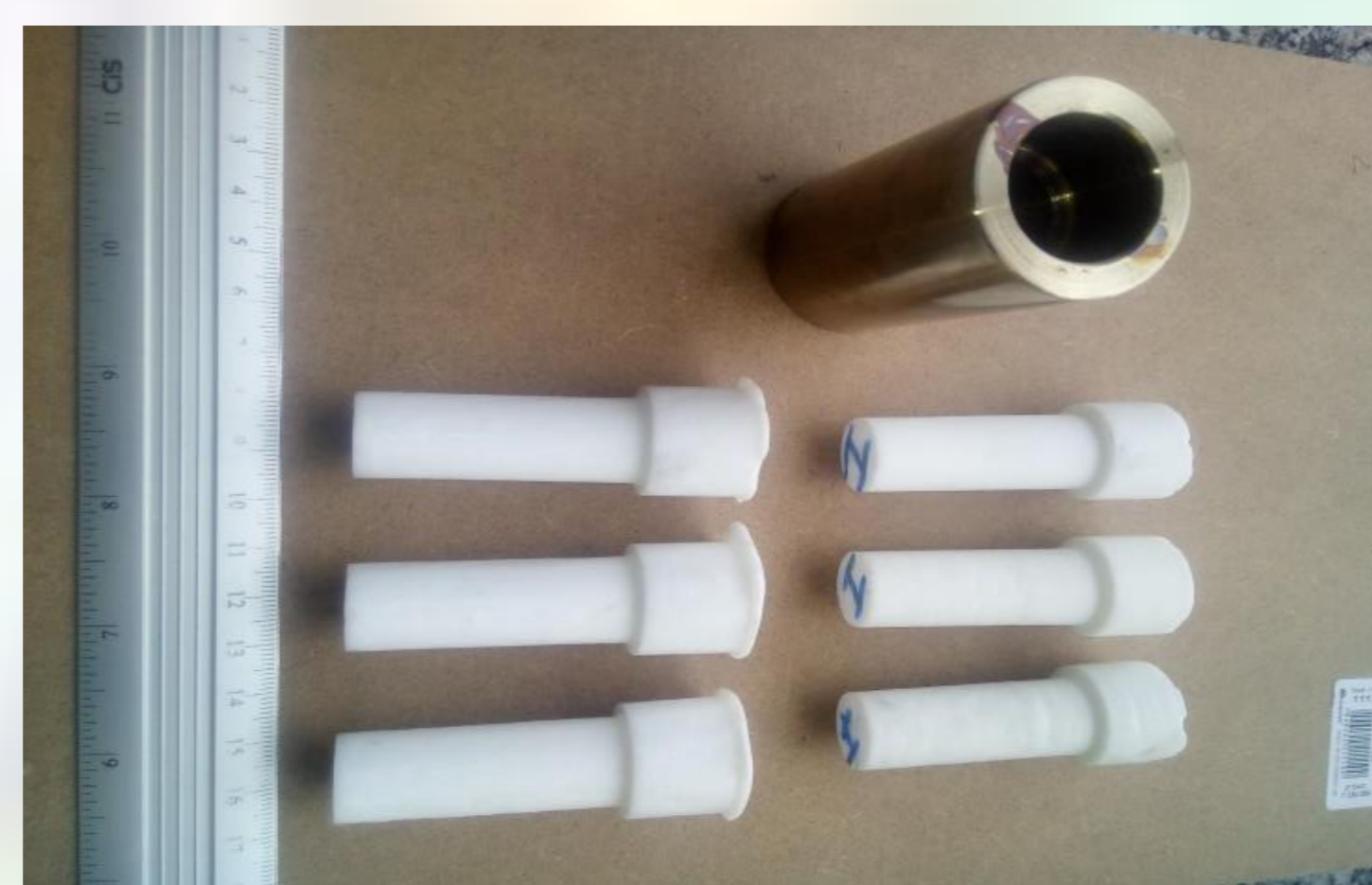
Figura 6: Corpos-de-prova de sal fundido e o molde metálico utilizada nesta fundição. Os modelos foram identificados e caracterizados a morfológica (DRX), a resistência mecânica (ensaio de compressão) e sua colapsibilidade em água na fundição de alumínio.
