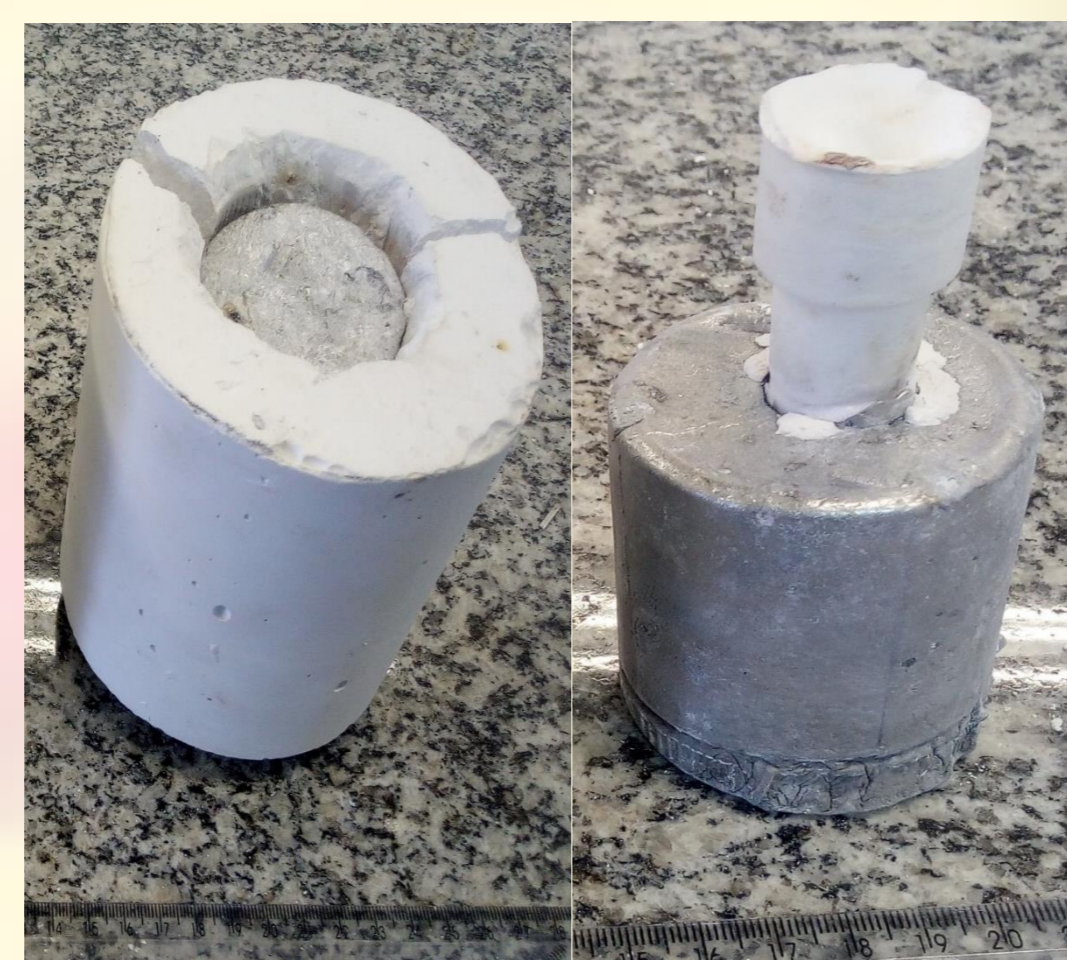
Figura 8: Sequência da fundição de alumínio no molde de gesso com macho de sal fundido.
