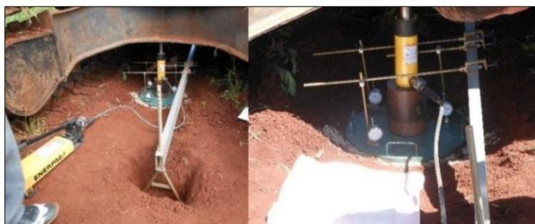
Figura 1. Execução dos ensaios de placa.
