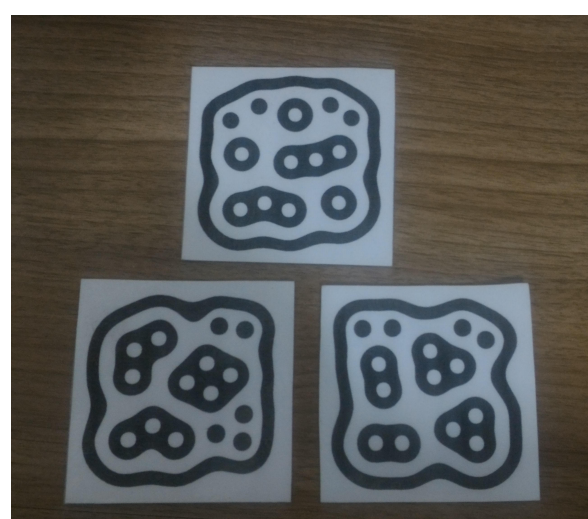
Marcadores fiduciais do reactIVision impressos em cartões
