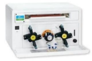
Analisador de Hg, Perkin Elmer, modelo FIMS 400 Fonte de radiação: lâmpada de baixa pressão de Hg  $\lambda = 253,7$  nm
