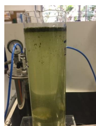
Figura 3: Flotação por ar dissolvido para a remoção de microalgas.
