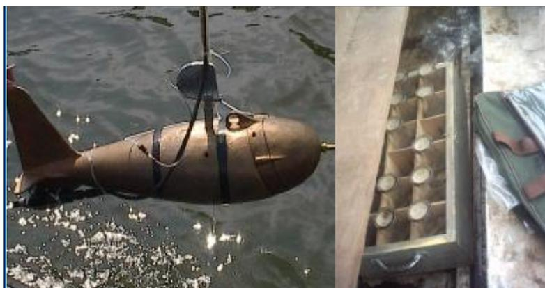
Figura 4.4 – Amostrador P-61 com o bico na entrada e as garrafas de amostragem
