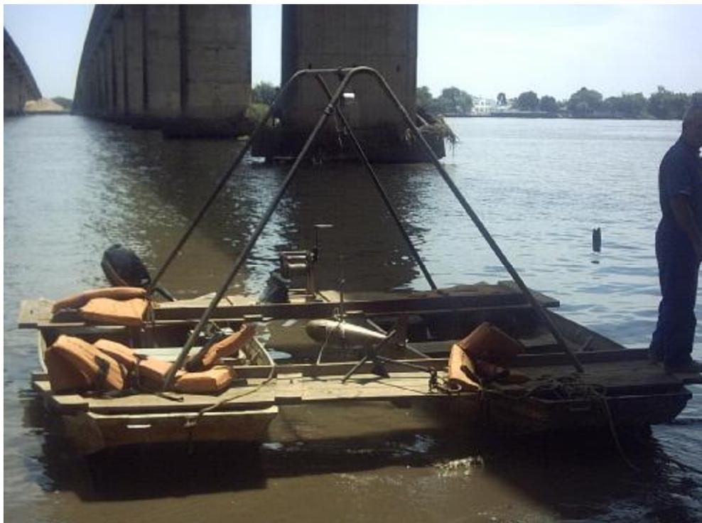
Figura 4.6 – Estrutura do amostrador de sedimentos utilizada na 1ª medição
