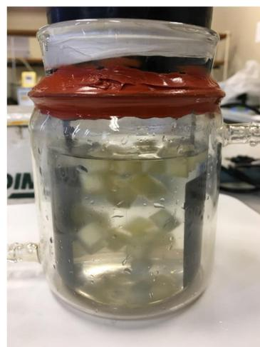
Figura 2 – Célula utilizada nos experimentos de branqueamento
