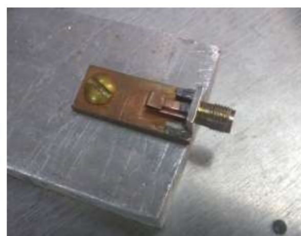
Figura 2. Foto da linha de transmissão construída.
