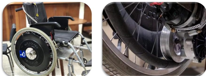
Figura 1: Cadeira de rodas adaptada e acoplamento mecânico utilizando polias.
