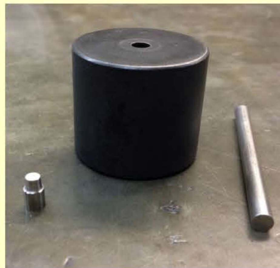
Bushing e pinos usados como pistões
