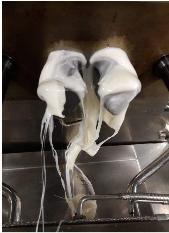
Figura 9 – Blenda fundida ao sair do interior da câmara de mistura.
