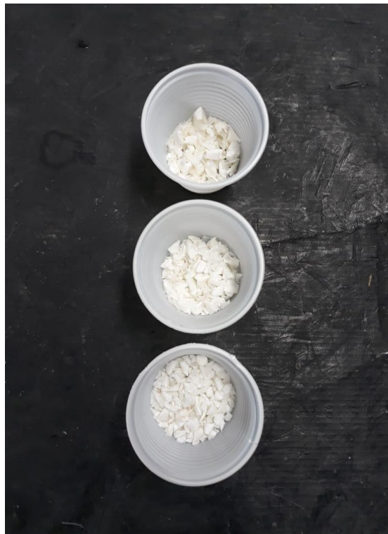
Figura 10 – Material fragmentado, pronto para ser alimentado na injetora para produção dos corpos de prova.
