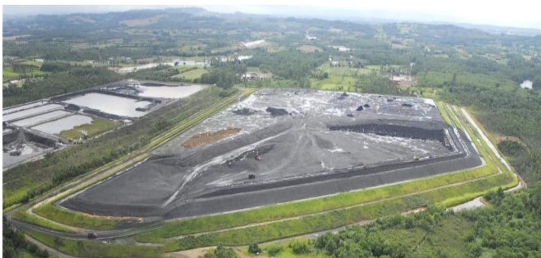
**Figura 5. Imagem de um depósito de rejeitos de carvão em operação na região Carbonífera de Santa Catarina (cortesia de Carbonífera Criciúma S/A, 2009).**
