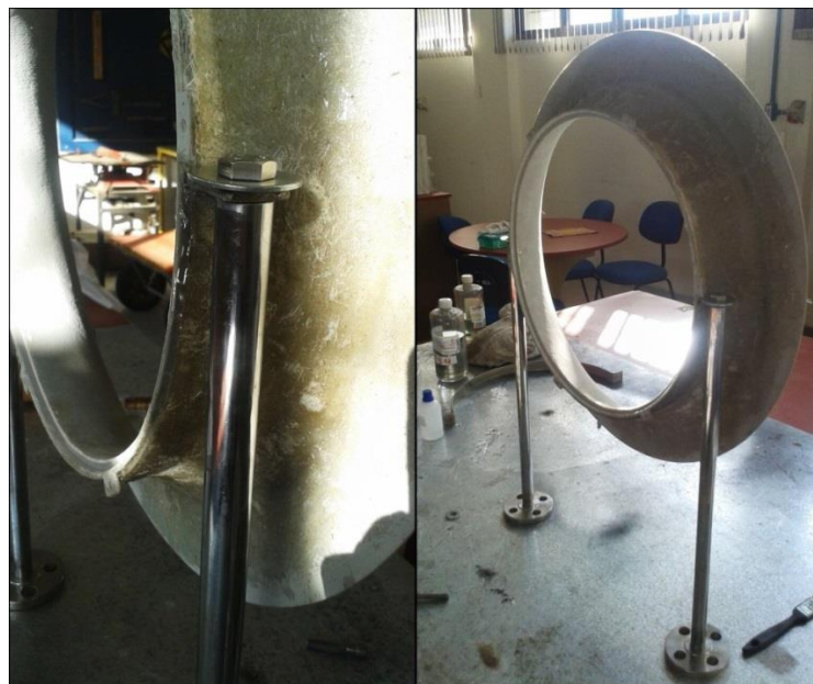
Figura 3.12 – Construção do bocal, laminação e suportes da turbina.
