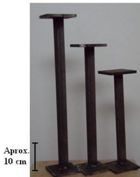
**Figura 5.2: Corpos de prova ensaiados à compressão centrada**
